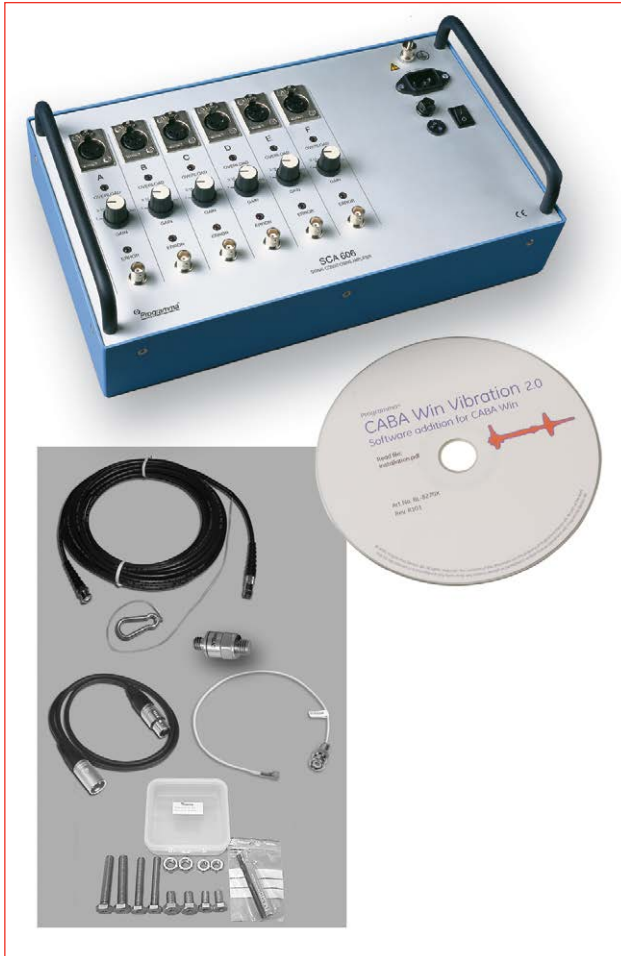
Juego de vibraciones, BL-13090 incluye: SCA606, software CABA Win Vibration y un canal de vibraciones
