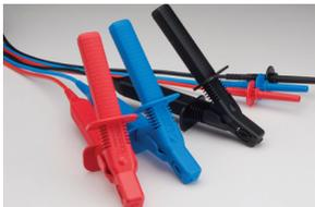
Clasificación de aislamiento del juego de cables de 10 kV: 12 kV CC. (marcado en el cable) Tipo de cable: silicona con aislamiento doble y flexible (capa de aislamiento interior de color blanco para destacar el daño)
