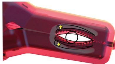
La pinza de Megger se analiza con el instrumento de ensayo estándar del IEC para detectar fugas y holgura.
