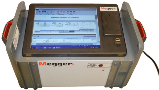
MWA330A con computadora industrial de 12 pulgadas incorporada, ilustrado arriba.
