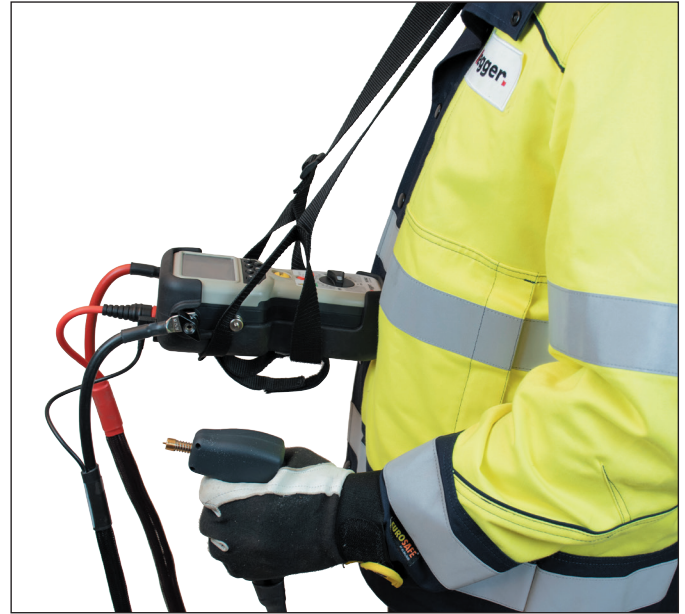
Correa de transporte que facilita el trabajo al medir con dos sondas. Incluido con el instrumento.
